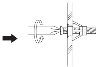
付属ビスを右に回し、壁裏のボードアンカーが開き、壁に固定できたか確認してください。
