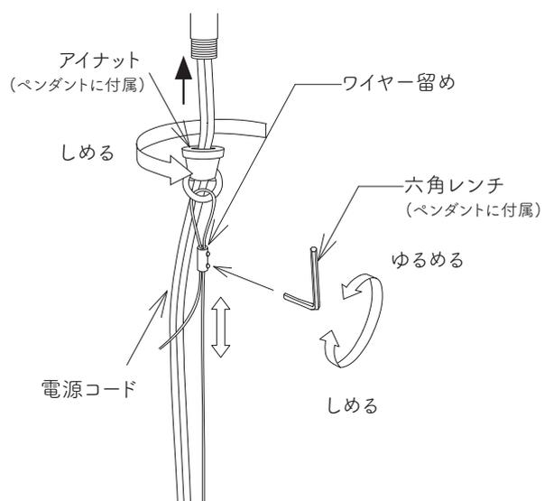
事前に吊り高さを決め、コードクリップにて電源コードを固定して下さい。
