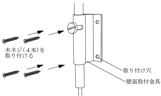
付属の木ネジ(4本)で壁面固定金具を壁面の補強材のある位置に取り付けてください。
