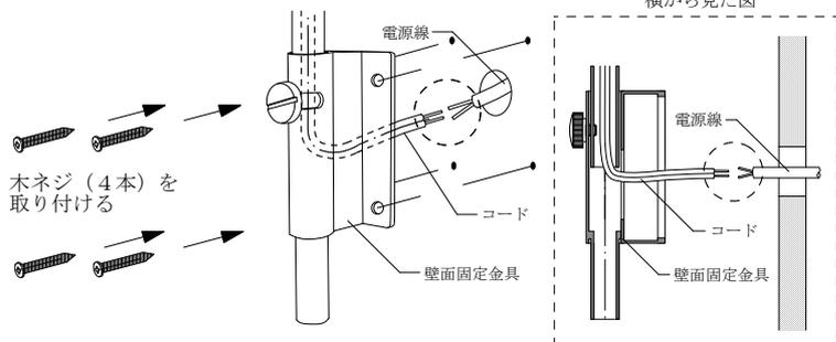
金具の裏面の穴からコードをぬき、壁面からの電源線と結線をしてから、壁面に取付けてください。
